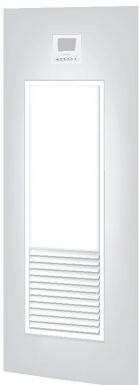
Step 1 Access fan coil
