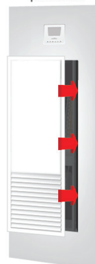
Step 7 Replace access panel door
